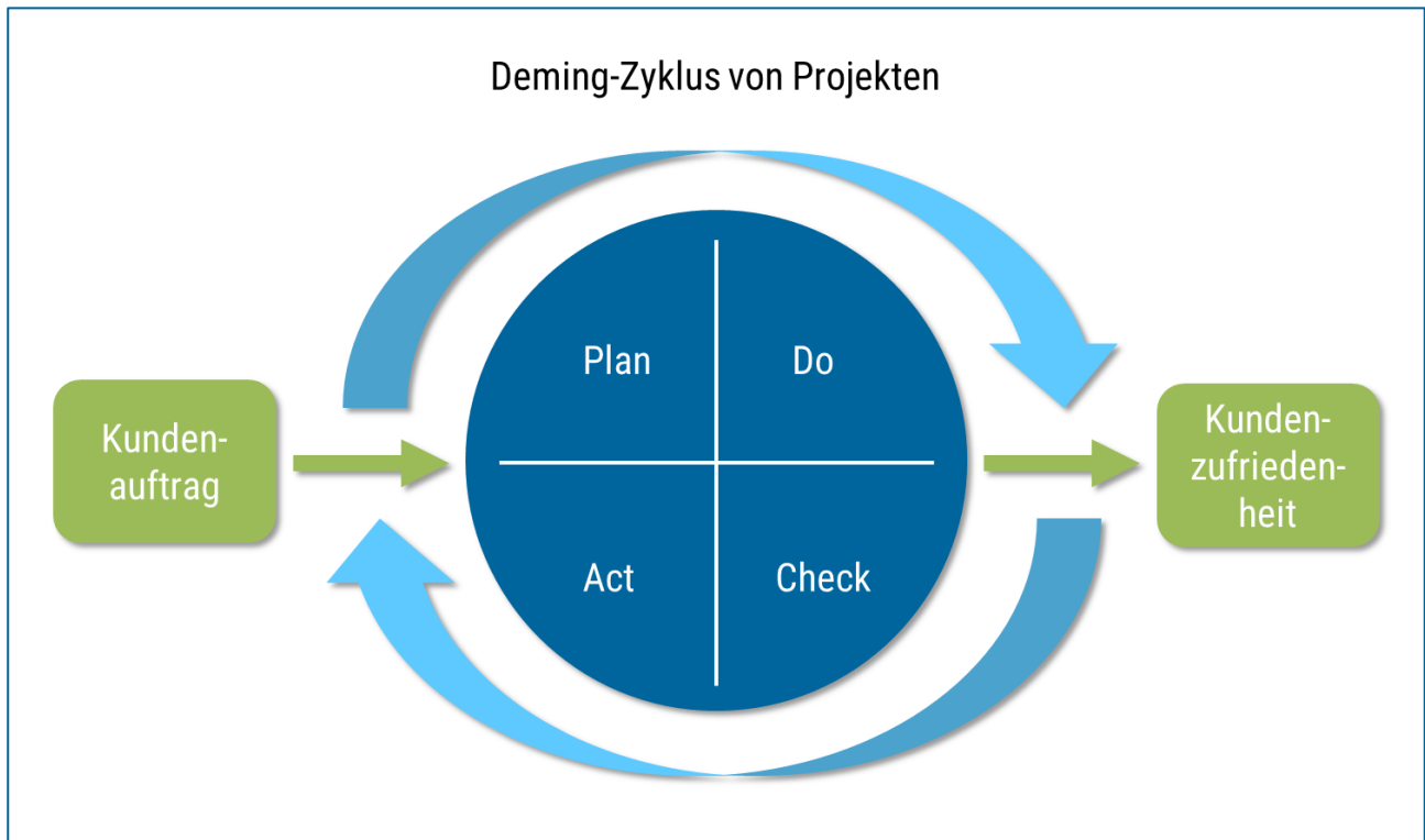
Abbildung 6: Allgemeines Schema der iterativen Qualitätsverbesserung von Projekten, wie es in einschlägigen DIN- und ISO/IEC-Normenfamilien zum Ausdruck kommt. Jeder Iterationsschritt besteht aus einem Plan-Do-Check-Act-Zyklus ( Deming-Zyklus ), in welchem ein Projekt zunächst geplant ( Plan ), dann ausgeführt ( Do ), dann geprüft ( Check ) und schließlich verbessert ( Act ) wird.
